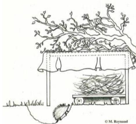
**2- Le gîte récup'.** Une caisse en plastique ou un cageot, surmontée d'une petite bâche, avec une entrée en creux (creuser un trou dans le sol, de 20cm de largeur et 6-7cm de profondeur. Ensuite, la caisse doit être bien recouverte de matériaux isolants (feuilles, branches...)
