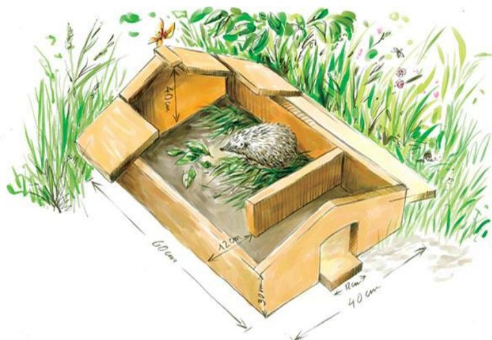
**1- Le caisson sur mesure.** Une caisse toute en bois avec plancher, murs, toit, et un couloir avec entrée décalée. Sur ce dessin, le toit et l'isolation extérieure avec des branches ou feuilles ne sont pas illustrés. Ne pas l'oublier !
