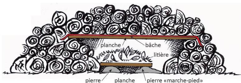
**3- La pile de bois truquée.** Une chambre aménagée dans la pile de bois. Une planche pour faire le toit, surmontée d'une bâche pour isoler de l'humidité. Sur le dessin ne figure pas l'entrée, qui doit être petite (environ 10-15 cm de diamètre). Elle peut être aussi un tuyau de brique ou PVC.
